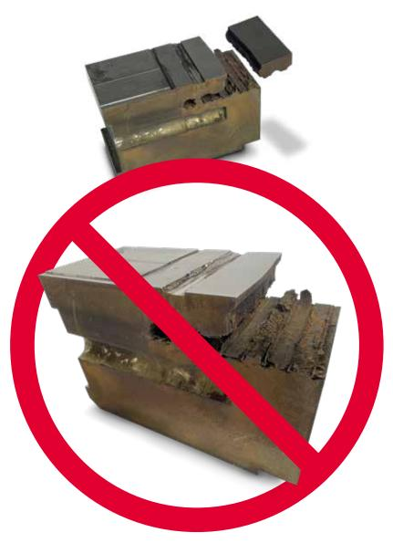
Hier sieht man starke Korrosionsschäden, die zum Bruch des Werkzeugeinsatzes geführt haben
