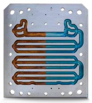
Die Funktion eines konturfolgend temperierten Werkzeugeinsatzes ist von einer unbeeinträchtigten Oberfläche abhängig. Darum bieten wir jetzt auch unsere eigene Kanalbeschichtung als Option an.
